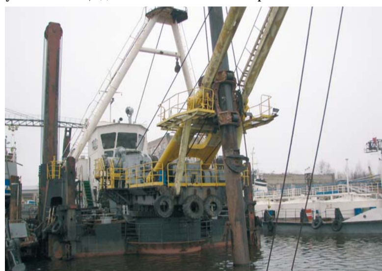
Штанговый земснаряд в Шлиссельбурге. От опрокидывания судно удерживают мощные опоры-сваи в его кормовой части.
